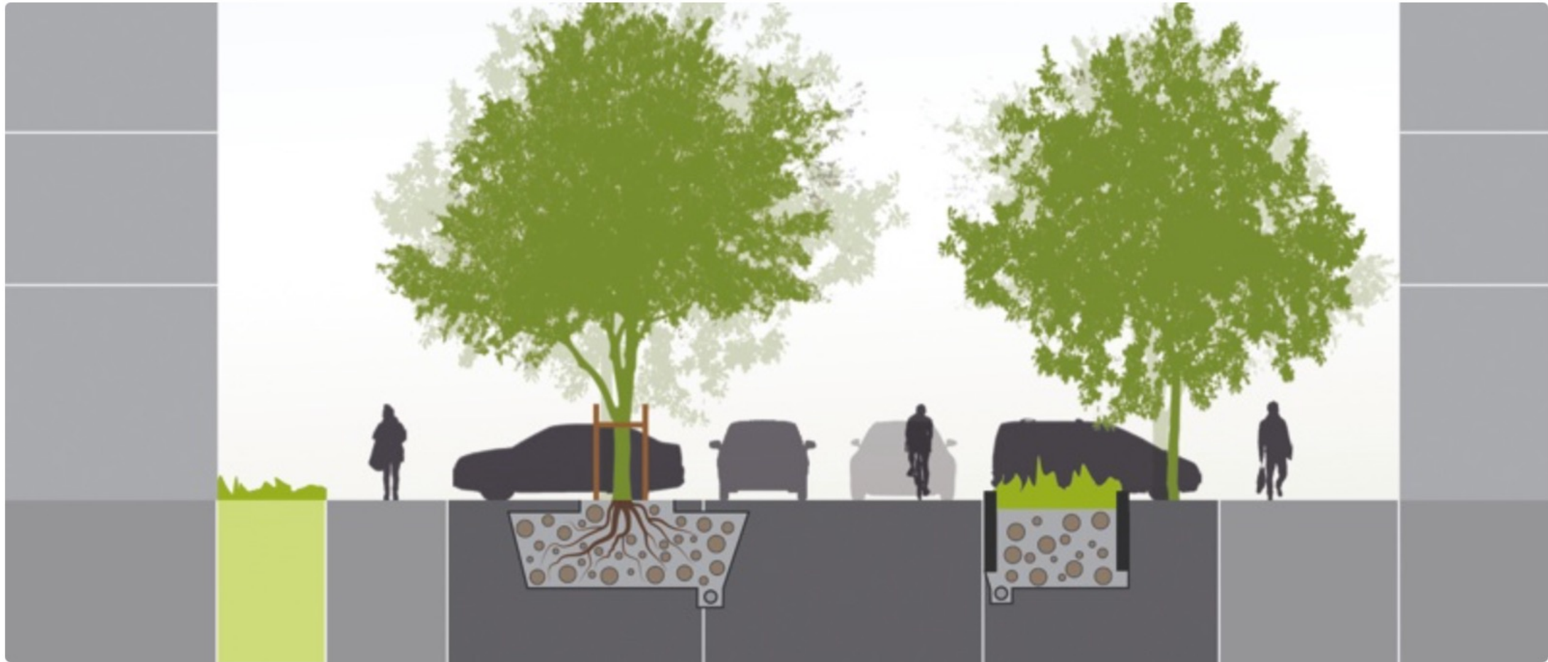
Begrünte Straße bei Sonne mit versickerungsfähigen Pflanzgruben von Straßenbäumen und Tiefbeete
