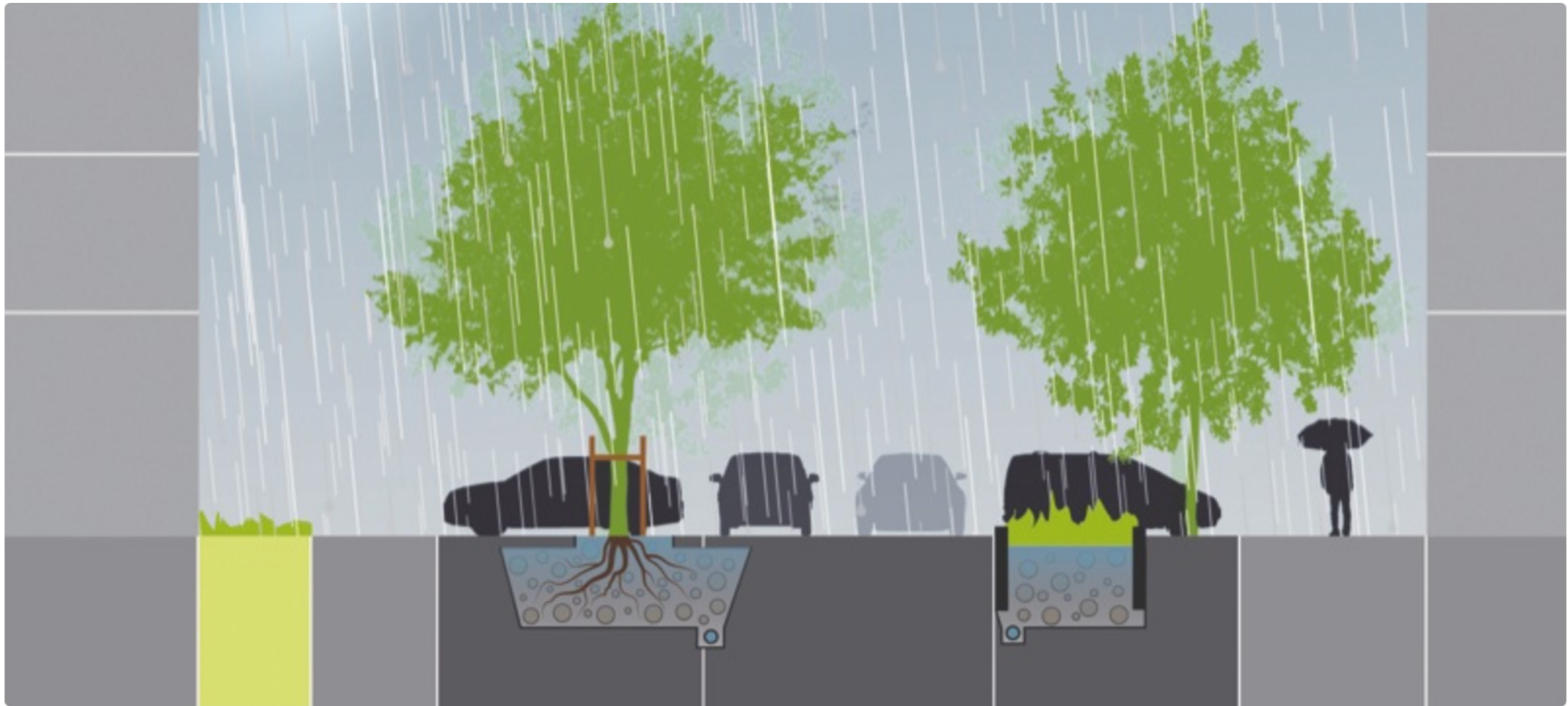
Begrünte Straße bei Regen mit versickerungsfähigen Pflanzgruben von Straßenbäumen und Tiefbeeten
